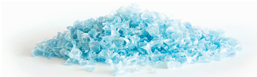
Bild 2. Voraussetzung für sortenreine und zu 100 % wiederverwertbare PET-Flakes aus Post-Consumer-Abfällen sind effektive Sammel- und Rücknahmesysteme. Trotz der anhaltenden Kritik ist PET in diesem Punkt ein Erfolgswerkstoff (© Erema)
